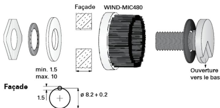
**Note:** Le WIND-MIC480 peut aussi être utilisé avec d'autres microphones (ceux de la série WS par exemple). Dans ce cas, il doit être monté avec l'adhésif double face inclus dans la livraison.
