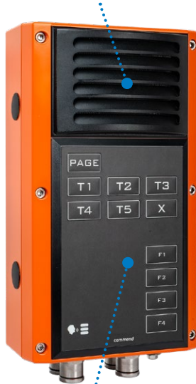
Taktiler Tastenbedienfeld mit Party-Line Tastatur und 4 programmierbaren Funktionstasten
